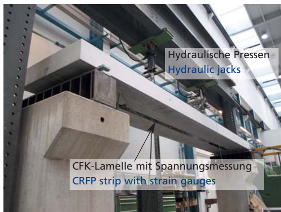
Fig. 5 Versuchsaufbau. Bending test setup.
